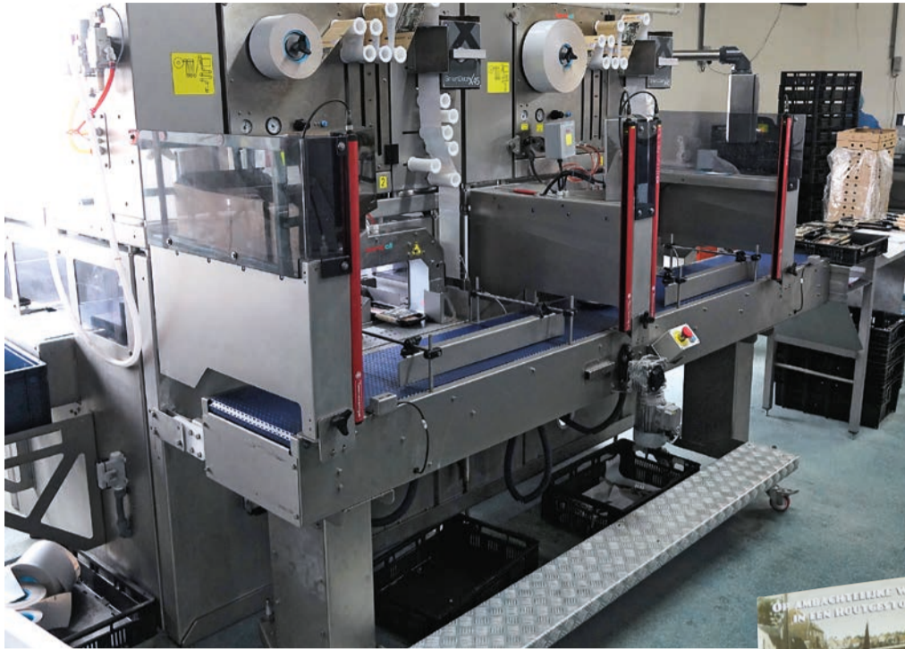
De Bandall TRCS machine bij Klooster bestaat is dubbelkops uitvoering die een maximale snelheid van 40 verpakkingen per minuut kan verwerken.
